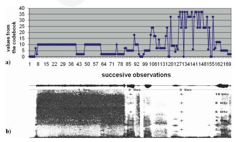
Fig. 4. The "ssssssssssawka yn yn nach" utterance – a) encoded, b) spectrogram
